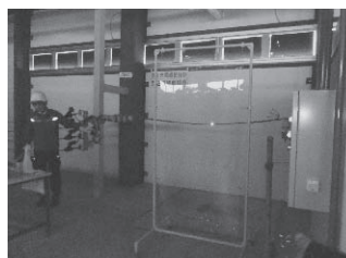
引込線被覆損傷再現、 音と火花発生
